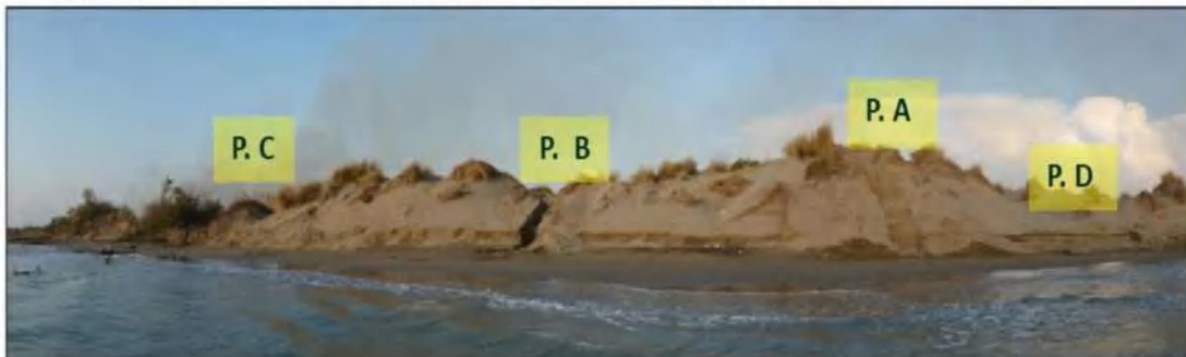
Figura II.1.7. Profilet e hapura (A-D) në kordon dunor për kryerjen e analizave granulometrike, mineralogjike dhe kimike.
