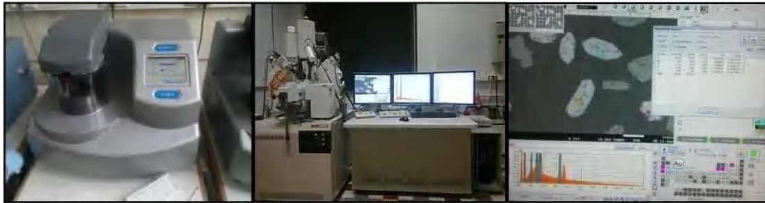
Figura II.1.28. a) Instrumenti Quorum Q150T ku kampioni në shlif mbulohet me karbon; b) instrumenti EPMA; c) Paraqitja e faqes së punës gjatë analizës së mineralit të zirkonit. Të dhënat e detajuara teknike: https://www.mtm.kuleuven.be/english/Equipment/Sheets/field-emission-microprobe-jxa-8530f
