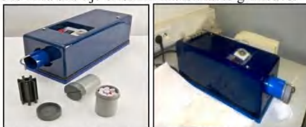
Figura II.1.16. a) mbajtësi plastikë me bluarësit prej korundi b) Kanistra ku qëndron kampioni për tu bluar deri në 10 \mu m.
