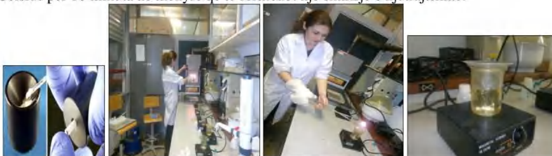
Figura II.1.20. a) mbajtësja grafit, b & c) marrja e kampioneve nga furra me pinceta, hedhja e përbërjes në tretësirë, d) tretësira e vendosur në magnet trazues.
