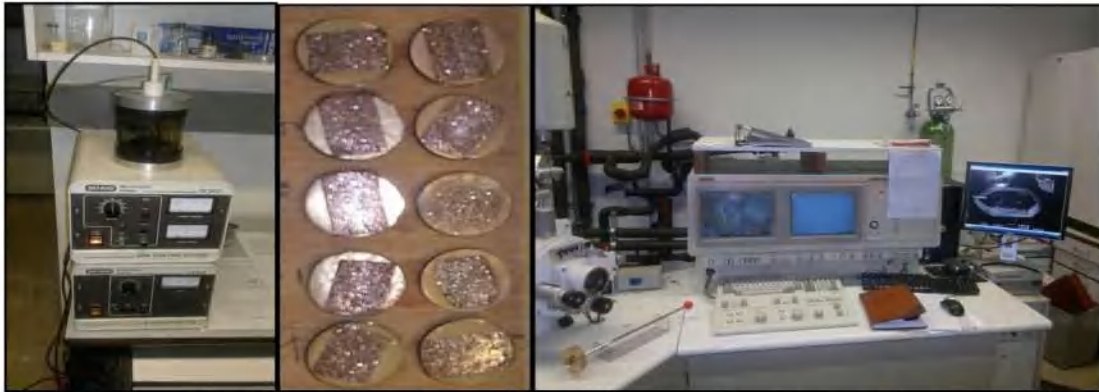
Figura II.1.26. a) Pajisja SEM coating System, Bio-Rad SC 502; b) Kampionet e zirkonëve të mbuluara me ar. c) Pajisja SEM Jeol JSM 6400 (KU Leuven).
