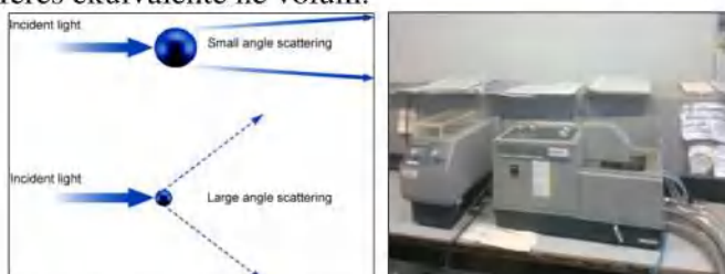
Figura II.1.9: a) Këndi i shpërndarjes së dritës për grimca të vogla dhe të mëdha; b) pajisja me të cilën janë kryer analizat e granulometrisë.
